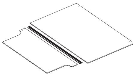
STEP 3 : SLIDE ON FLOOR JOINER 1340 TO OPPOSITE EDGE OF PTKTFFTCSWBMID. POSITION PTKTFFTCSWBRR ON OPPOSITE SIDE OF JOINER AND FIT INTO POSITION. ENSURE TEXTURED FACE IS UPWARDS.
